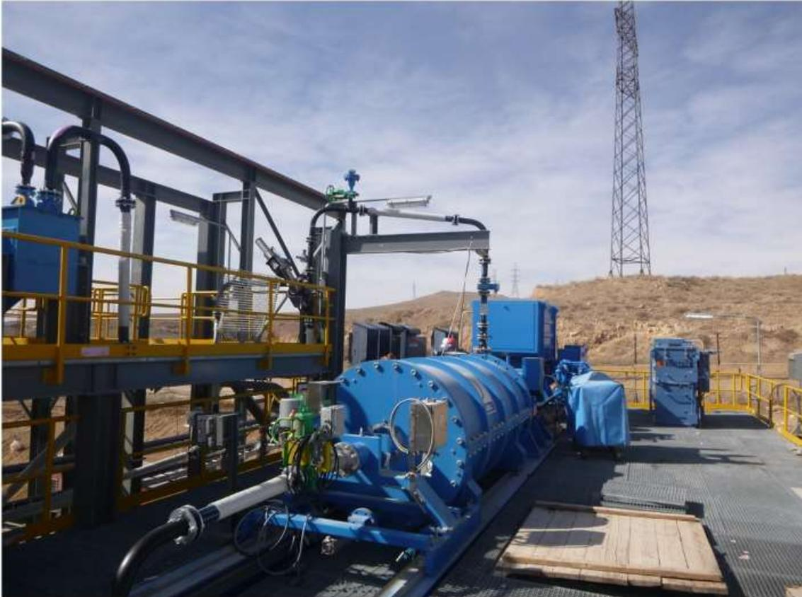
**Figure 1: Ultrafine Grinding ( IsaMill™ )**
